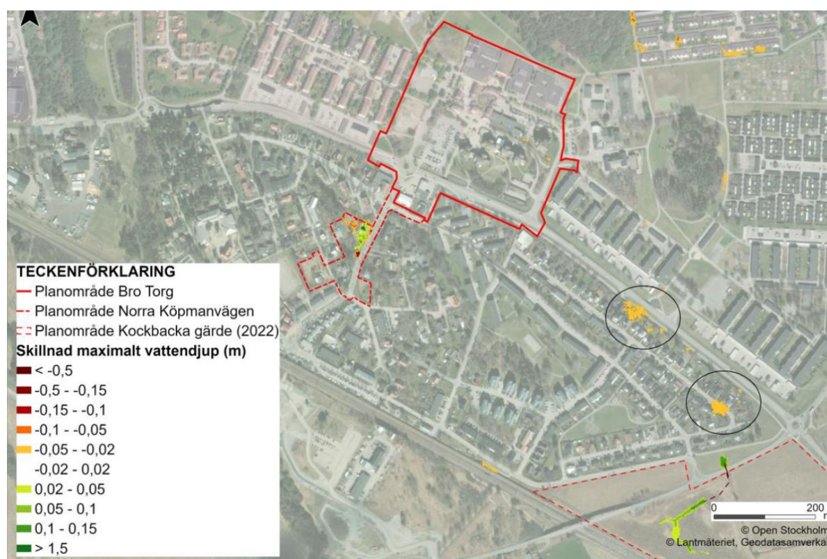
Figur 32. Skilnadskarta som jämför förändring mellan nuläge och genomförande av planförslaget, om inte Bro torg genomförs eller andra åtgärder vidtas. Ytor som väntas få 2-4 cm högre vatten om planförslaget är inringade. (bild, Sweco)
