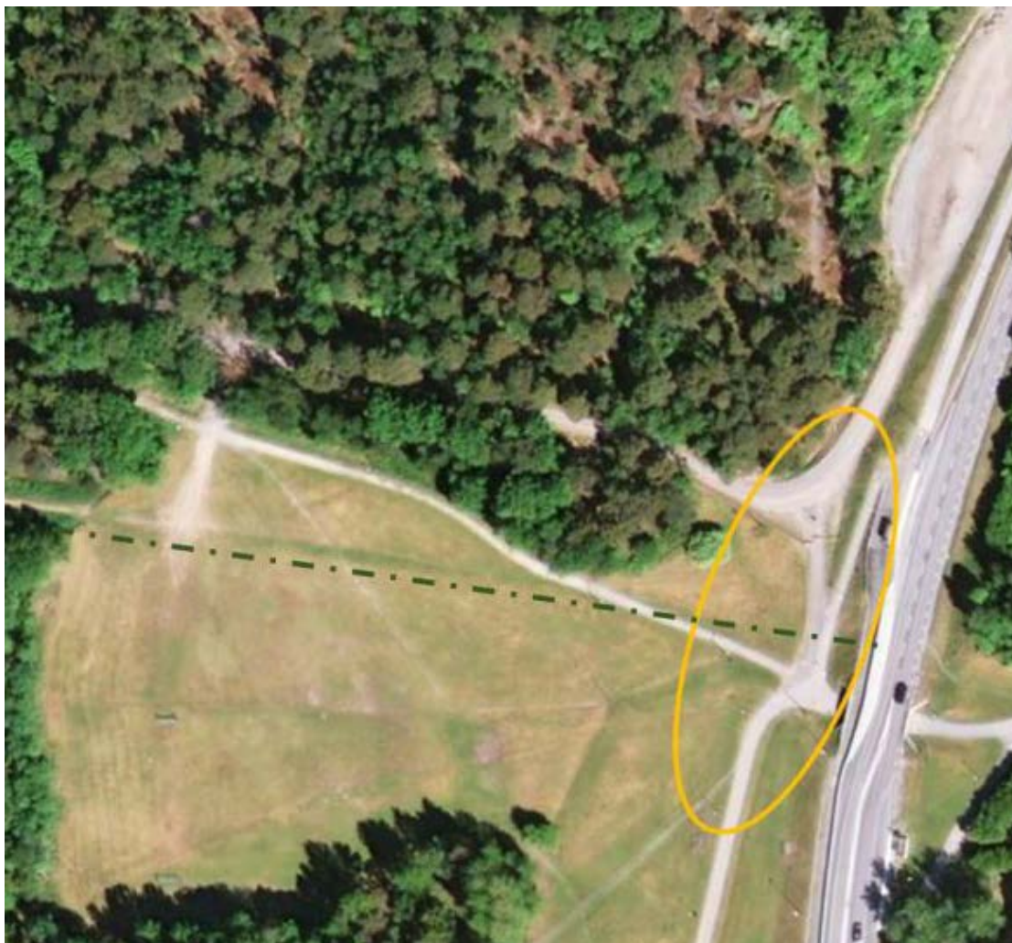
Figur 19. Grön streckad linje visar ungefärligt läge för dagvattenledning där vatten får släppas på. Gul markering visar det område dit naturlig höjdsättning leder vatten.
