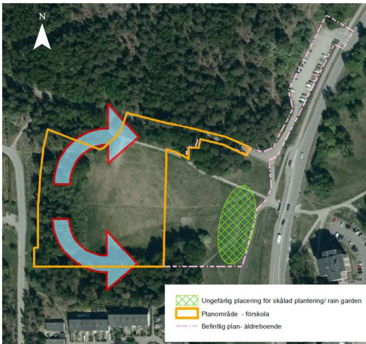
Figur 20. För att undvika att vatten rinner in på planområdet rekommenderas ett avskärmande dike längs dess gräns, så att det inkommande vattnet istället leds runt planområdet.
