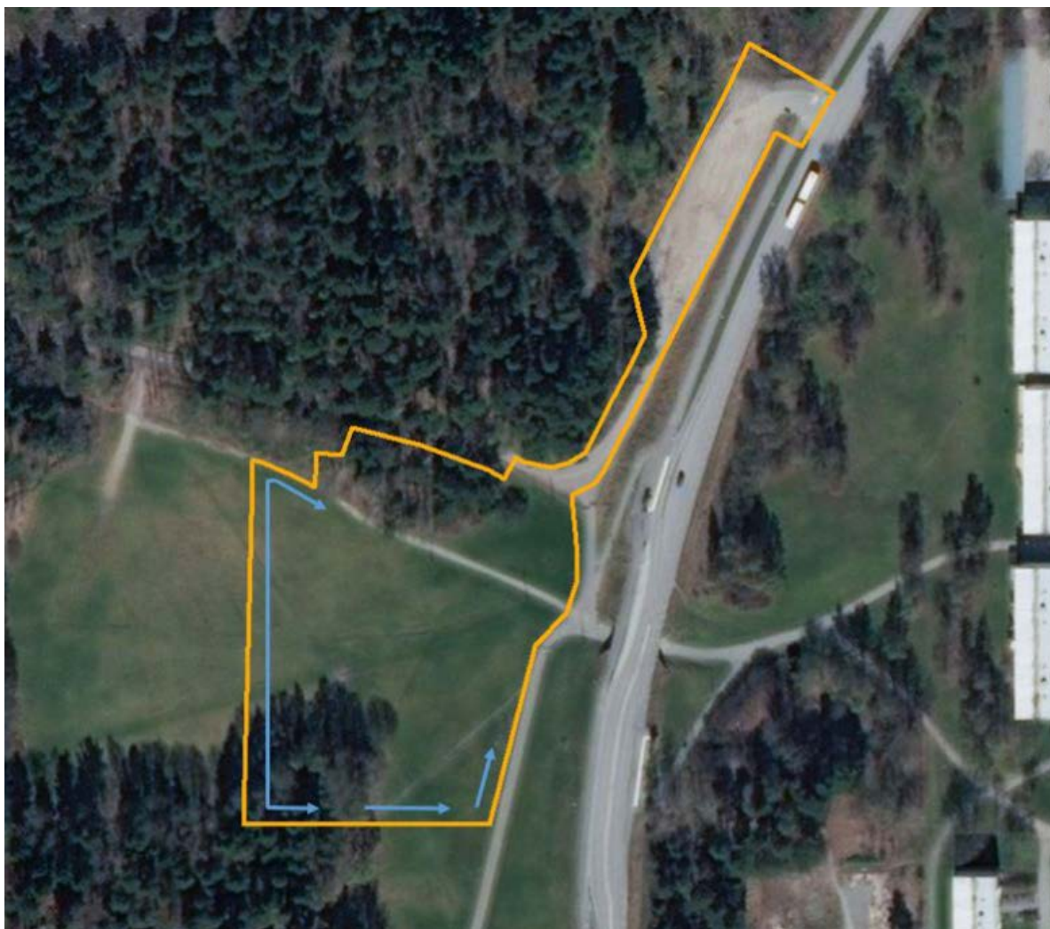
Figur 17. För att undvika att vatten rinner in på planområdet rekommenderas ett avskärande dike längs dess gräns, så att det inkommande vattnet istället leds runt planområdet.
