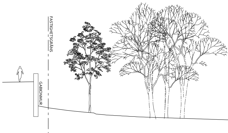
Exempel gabionmur mot fyllnad av kvartersmark, skala 1:200.
