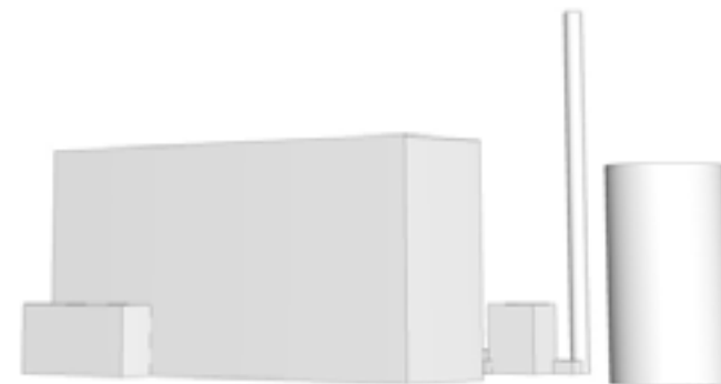
Schematisk bild som redovisar faktiska storleksförhållanden mellan pannbyggnad, ackumulatortank, skorsten med rökgasrening och övriga bilokaler. (Sweco)
