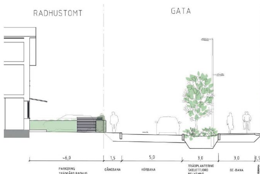
Gatusektion över lokalgatan, gång- och cykelbanan samt förgårdsmarken vid bostäderna av Topia
